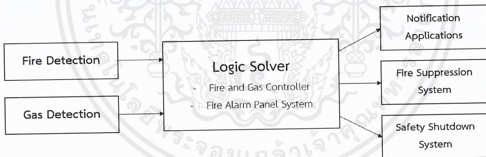
ภาพที่ 2.55 ส่วนประกอบหลักของ Fire and Gas System
