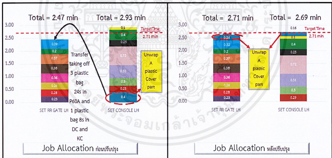
รูปที่ 4.5 แผนภูมิแสดงการเปรียบเทียบเวลาการทำงานในสถานีงานก่อนการปรับปรุงและหลังการปรับปรุงของรถยนต์โมเดล KC (นิสสัน นาวาร่า คิงแคป)
