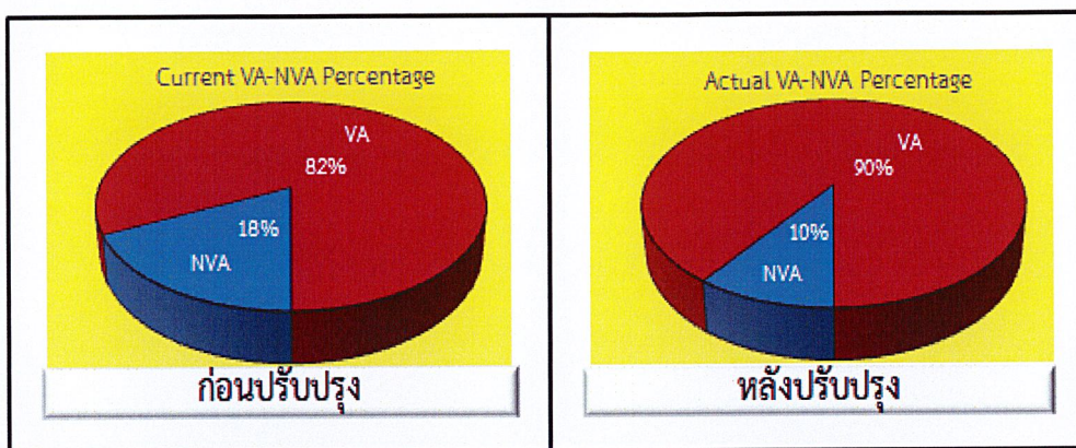
รูปที่ 4.2 แผนภูมิแสดงการเปรียบเทียบกิจกรรมที่ไม่ก่อให้เกิดคุณค่า ก่อนการปรับปรุงและหลังการปรับปรุงในสถานีงาน MTG CAB RH ของรถยนต์โมเดล DC (นิสสัน นาวาร่า ดับเบิลแคป)
