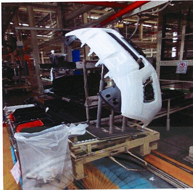
รูปที่ 3.7 หลังจากได้รับการปรับปรุงกล่องบรรจุชิ้นส่วนที่ได้รับการดัดแปลงให้บรรจุกันชนหน้าลงไปได้
