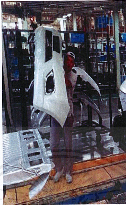
รูปที่ 3.5 ก่อนได้รับการปรับปรุง พนักงานเสียเวลาในการเดินเพื่อไปหยิบกันชนหน้าจากคลังบรรจุเพื่อนำกลับมาประกอบ
