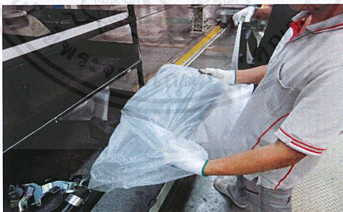
รูปที่ 3.9 งานที่ทางผู้จัดทำได้ทำการย้าย คือ ถอดถุงห่อหุ้มชิ้นส่วนในการประกอบ
