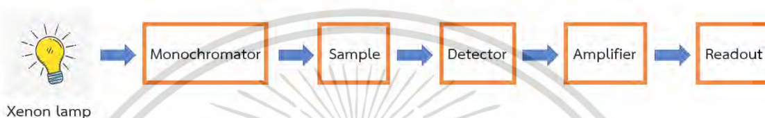
รูปที่ 3.4 ส่วนประกอบของเครื่อง UV/Vis Spectrometer
