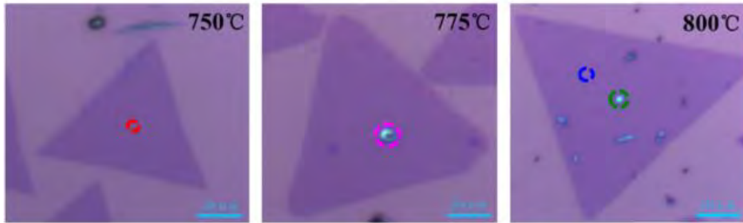
รูปที่ 2.11 ภาพถ่ายจากกล้องจุลทรรศน์แบบใช้แสงของ \text{MoS}_2 ที่สังเคราะห์ด้วยเทคนิค CVD ภายใต้อุณหภูมิแตกต่างกัน [24]
