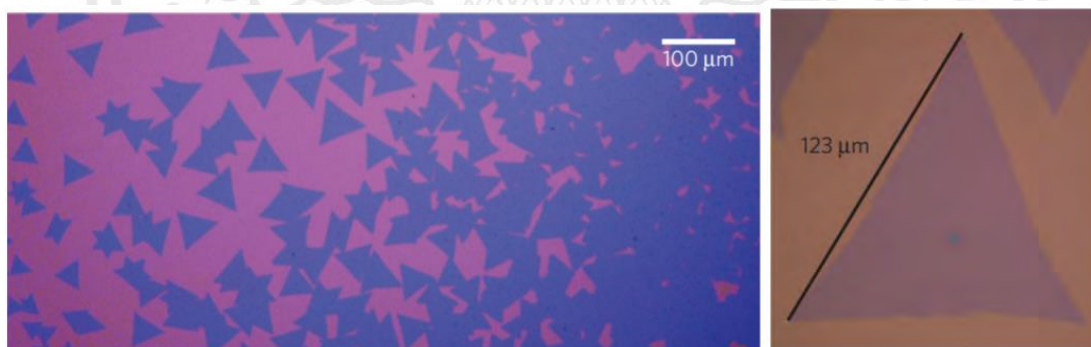
รูปที่ 2.8 ภาพถ่ายจากกล้องจุลทรรศน์แบบใช้แสงแสดงการรวมตัวกันของ \text{MoS}_2 รูปสามเหลี่ยมเป็นฟิล์มต่อเนื่องขนาดใหญ่และภาพขยาย \text{MoS}_2 ที่มีลักษณะเป็นรูปสามเหลี่ยมโดยสังเคราะห์ด้วยกระบวนการตกสะสมไอเชิงเคมี [22]
