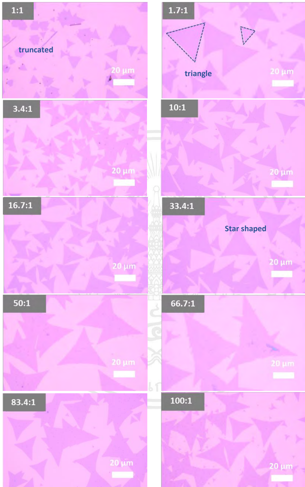
รูปที่ 4.9 แสดงภาพถ่ายวิวัฒนาการเกิดของโดเมนจากกล้องจุลทรรศน์แบบใช้แสงที่เกิดจากอัตราส่วนระหว่าง S:Mo แตกต่างกัน
