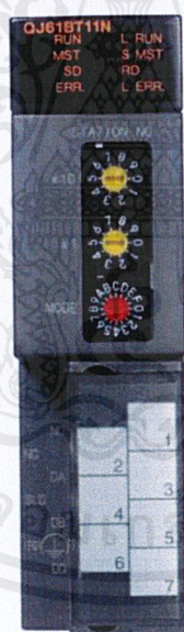
ภาพที่ 3.25 โมดูลรีโมท CC LINK (QJ61BT11N)
