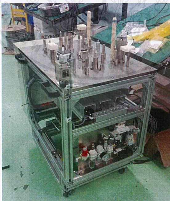
ภาพที่ 3.46 การติดตั้งอุปกรณ์ภายในตู้คอนโทรลเข้ากับเครื่องจักร
