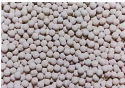
รูปที่ 2.15 โมเลกุลาร์ ซีฟ 13X (Molecular Sieve 13X)[35]
