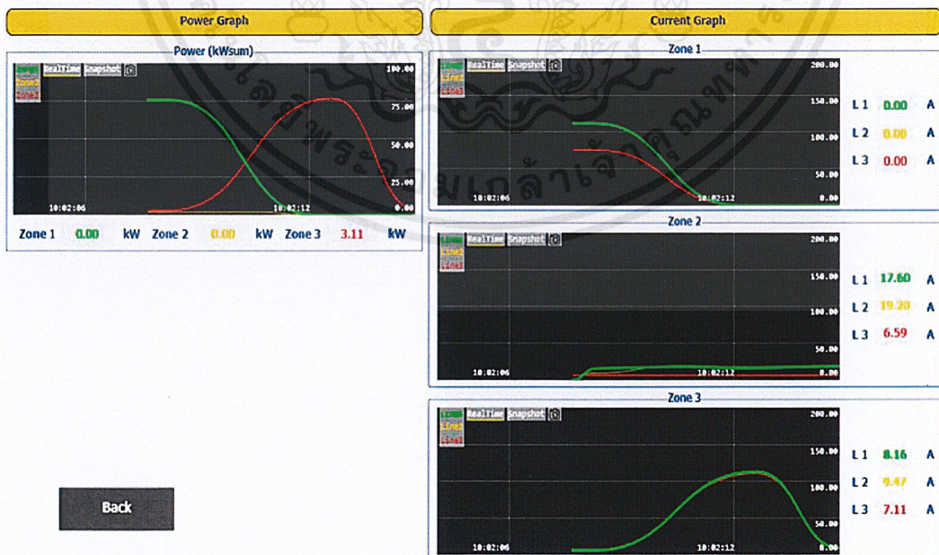
รูปที่ 4.8 หน้าเว็บเพจแสดงแนวโน้มของกำลังไฟฟ้าและกระแสไฟฟ้าแบบเรียลไทม์
