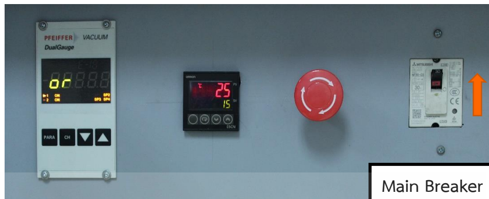
รูปที่ 3.7 การเปิดระบบทำของระบบสปีดเตอร์ริง
