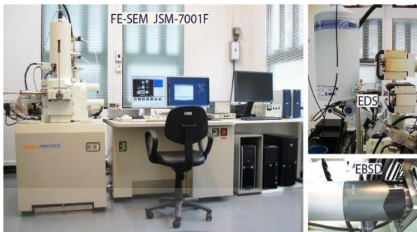
รูปที่ 2.32 กล้องจุลทรรศน์ อิเล็กตรอนแบบส่องกราด ความละเอียดสูง รุ่น JSM-7001F
