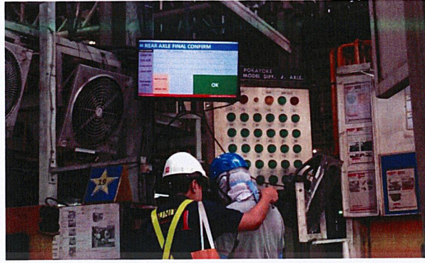
รูปที่ 4.1 การดำเนินทดลองใช้งานโปรแกรม Auto array Inspection
