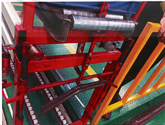
รูปที่ 3.30 ตัวอย่างกลไก Karakuri รับส่งชิ้นงานเข้ารถเข็น
