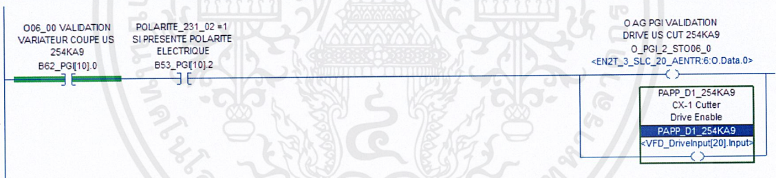
รูปที่ 3.40 Drive Enable รีเลย์ในโปรแกรมพีแอลซี
