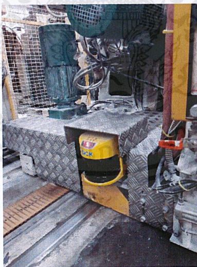
รูปที่ 4.1 เซฟตี้สแกนเนอร์รุ่น S30 6011-BA ที่ด้านซ้ายของเครื่องจักร BMTC
