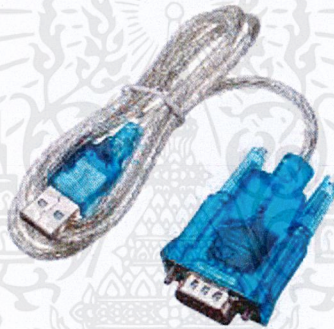
รูปที่ 3.6 สายแบบ RS-232/USB [25]
