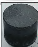
รูปที่ 3.7 เม็ดสารตั้งต้น Sn+Te ที่ผ่านการผสมและอัดแล้ว
