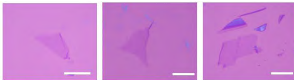
รูปที่ 4.1 แสดงภาพจากกล้องจุลทรรศน์ของกราฟีนที่บนพื้นผิวซิลิกอนไดออกไซด์จากวิธี Standard exfoliation สเกลบาร์ 10 ไมครอน
