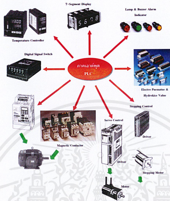
รูปที่ 2.12 ตัวอย่างอุปกรณ์เอาต์พุต (Output Device) ที่นำมาต่อกับภาคเอาต์พุตของ PLC
