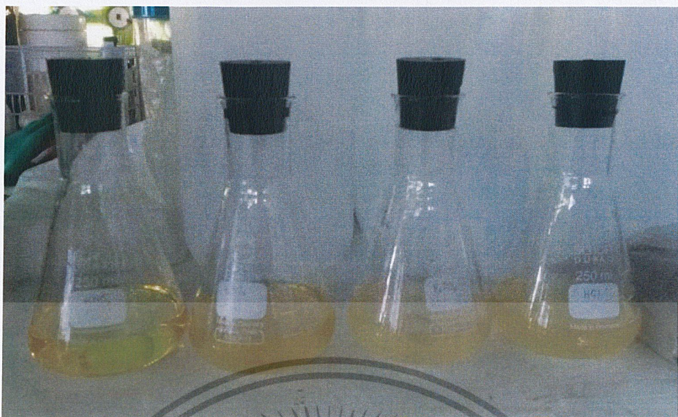
รูปที่ ข-5 ของเหลวที่กรองแยกออกจากของผสมระหว่างกรดกับ wastewater treatment sludge
