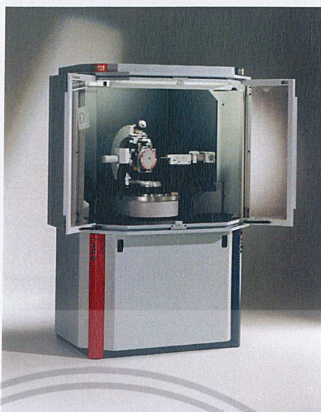
รูปที่ 2.8 เครื่องวิเคราะห์การเลี้ยวเบนรังสีเอกซ์ (XRD)
