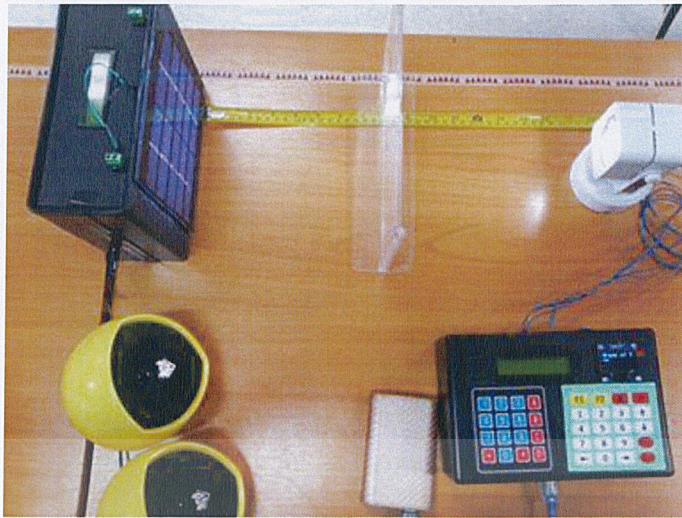
รูปที่ 4.26 ชุดทดลองรับส่งข้อมูลเสียง กับแผ่นใส ภายใต้ห้องสว่าง
