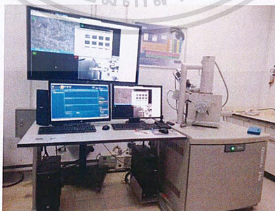
รูปที่ 3.7: Scanning Electron Microscopy (SEM) ที่ใช้ในโรงงานพิเศษนี้
