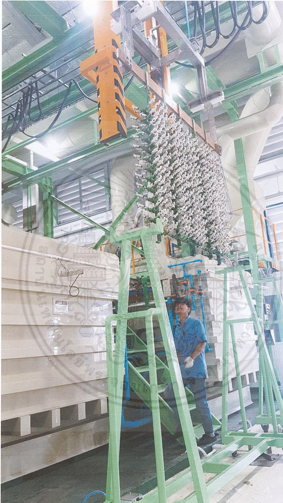
รูปที่ 4.15 Site Acceptance Test โดยการชูบชิ้นงานจริงในโหมด Automatic
