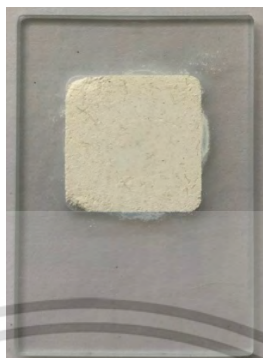
รูปที่ 3.21 การเตรียมอนุภาคตัวอย่างลงใน Sample holder
