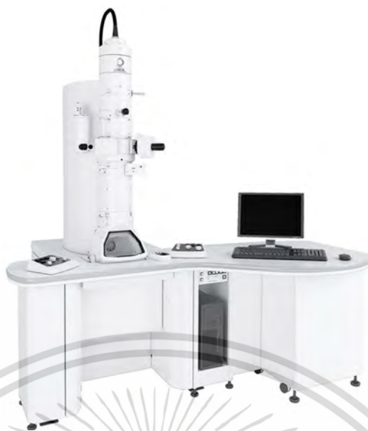
รูปที่ 3.18 เครื่องกล้องจุลทรรศน์อิเล็กตรอนแบบส่องผ่าน ยี่ห้อ JEOL รุ่น JEM-1400 [71]
