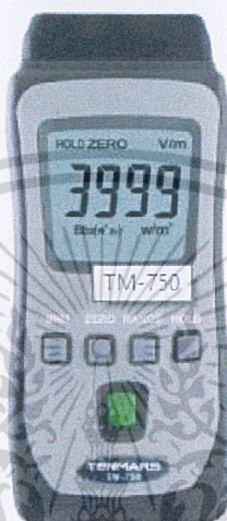
รูปที่ 3.11 เครื่องวัดค่าความเข้มแสงอาทิตย์ TENMARS TM – 750
