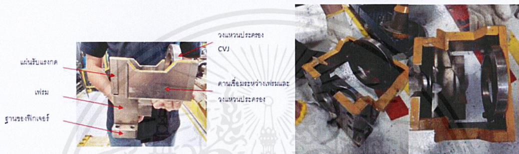
รูปที่ 48 ฟิกเจอร์ต้นแบบสำหรับการออกแบบ CVJ
