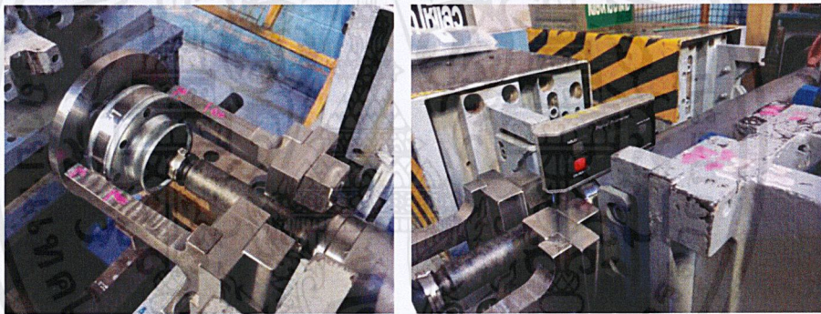
รูปที่ 105 การทดลองวางชิ้นงาน CVJ บน Fixture ก่อนการอัดจริง และการตรวจสอบมุมของแนวร่วมศูนย์โดยเครื่องมือวัด phaser จากภาพ CVJ ทำมุม -0.05 องศา กับแนวระดับของเครื่องจักร
