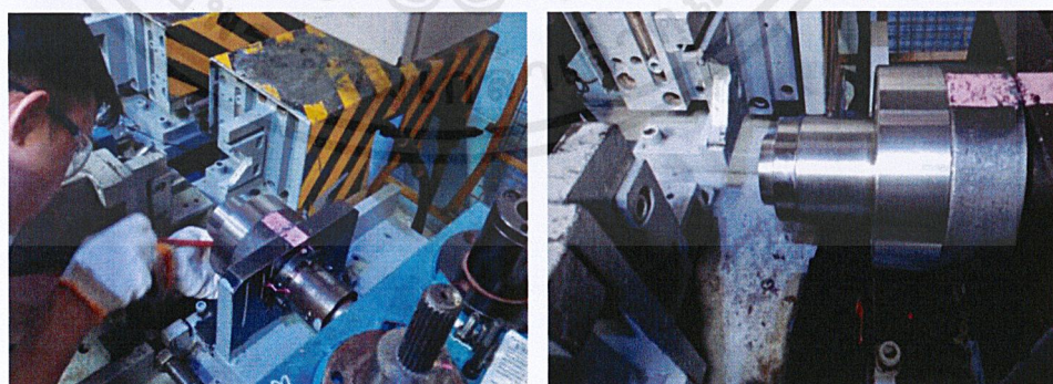
รูปที่ 101 แสดงการติดตั้ง Midship + Slinger Push up JIG
