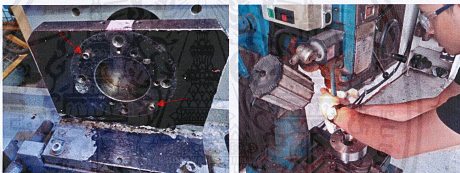
รูปที่ 100 แสดง Position Guide ของจิ๊กบนแท่นติดตั้งของเครื่องจักร และการปรับแต่งจิ๊กด้วยการเจาะรูเพิ่ม
