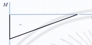
รูปที่ 72 แสดง shear และ moment diagram ของคานชนิด fix ปลายหนึ่งด้าน
