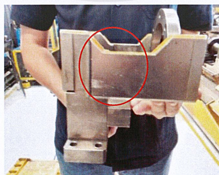
รูปที่ 69 แสดงตำแหน่งของคานเชื่อมจากตัวอย่างฟิกเจอร์ปัจจุบันในสายการผลิต
