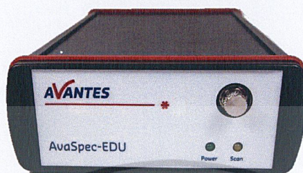
รูป เครื่อง Spectrometer บริษัท AVANTES รุ่น AvaSpec-EDU
