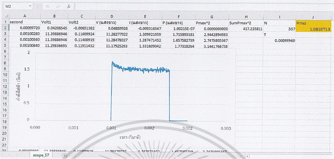
รูปที่ ก.11 แสดงค่าที่ได้จากการคำนวณกำลังไฟฟ้าจากการฉายแสงขาวแบบ Duty cycle 75 เปอร์เซ็นต์ ความถี่ 1 กิโลเฮิร์ต
