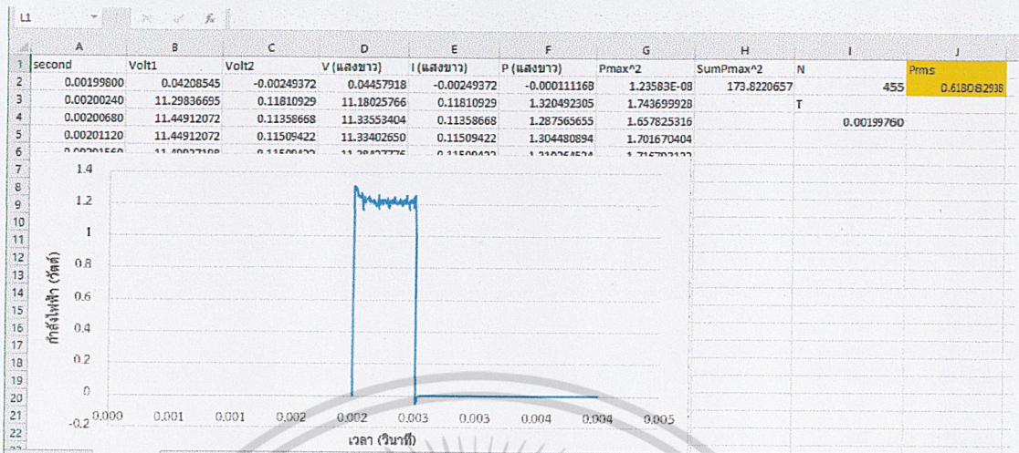
รูปที่ ก.16 แสดงค่าที่ได้จากการคำนวณกำลังไฟฟ้าจากการฉายแสงขาวแบบ Duty cycle 25 เปอร์เซ็นต์ ความถี่ 500 กิโลเฮิร์ต
