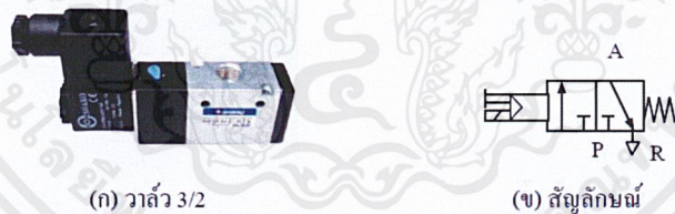
รูปที่2-19 วาล์ว 3/2 ปกติปิดเลื่อนวาล์วด้วยโซลินอยด์วาล์วกลับด้วยสปริง
