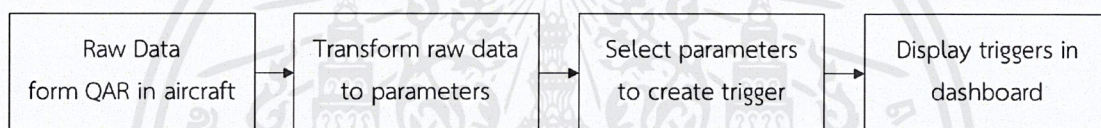
รูปที่ 3.1 บล็อกไดอะแกรมการทำงานของระบบวิเคราะห์ผลการปฏิบัติการบินของนักบิน
