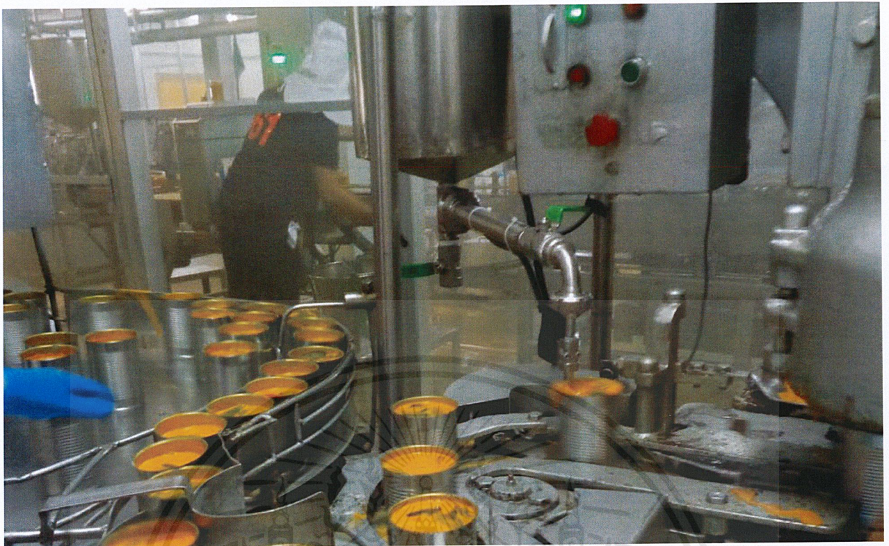
รูปที่ 3.20 ทดสอบเครื่องหยอดน้ำมัน
