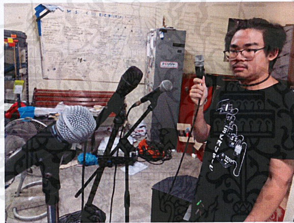
รูปที่ 3.4.4 ทดสอบการรับส่งสัญญาณของ XLR กับสาย CAT5E พร้อมกัน 4 สัญญาณ โดยใช้ไมโครโฟน 4 ตัว
