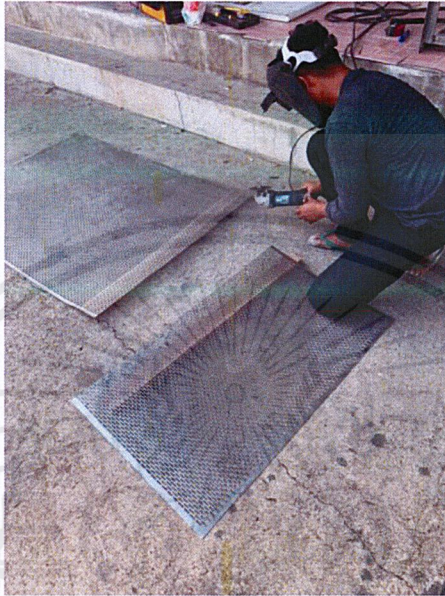
ตัดแบ่งตะแกรงเหล็กมีรูเพื่อเตรียมพร้อมสำหรับการประกอบตู้อลมเก็บเสียง
