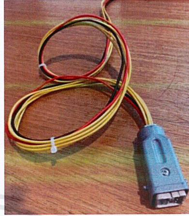
รูปภาพที่ 3.37 เต้าเสียบครอบด้วยปลอกหุ้มเมื่อบัดกรีรวมกับสายไฟเสร็จสมบูรณ์
