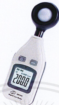
รูปที่ 3.33 เครื่องวัดความสว่าง BENETECH GM1010
