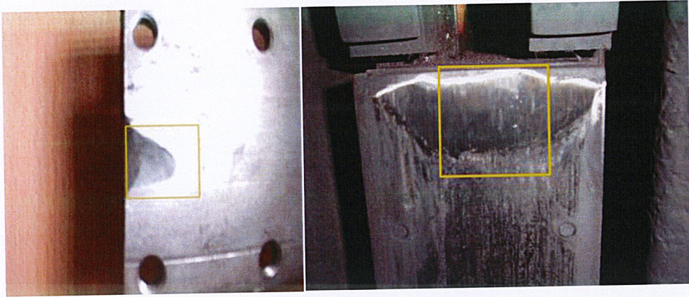
รูปที่ 4.5 รอยความเสียหายที่ถูกตรวจจับ
