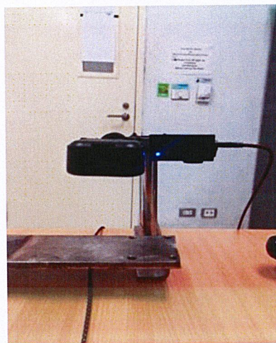
รูปที่ 3.35 การติดตั้งไฟLED ทำมุม 90° กับผิวชั้นทดสอบ
