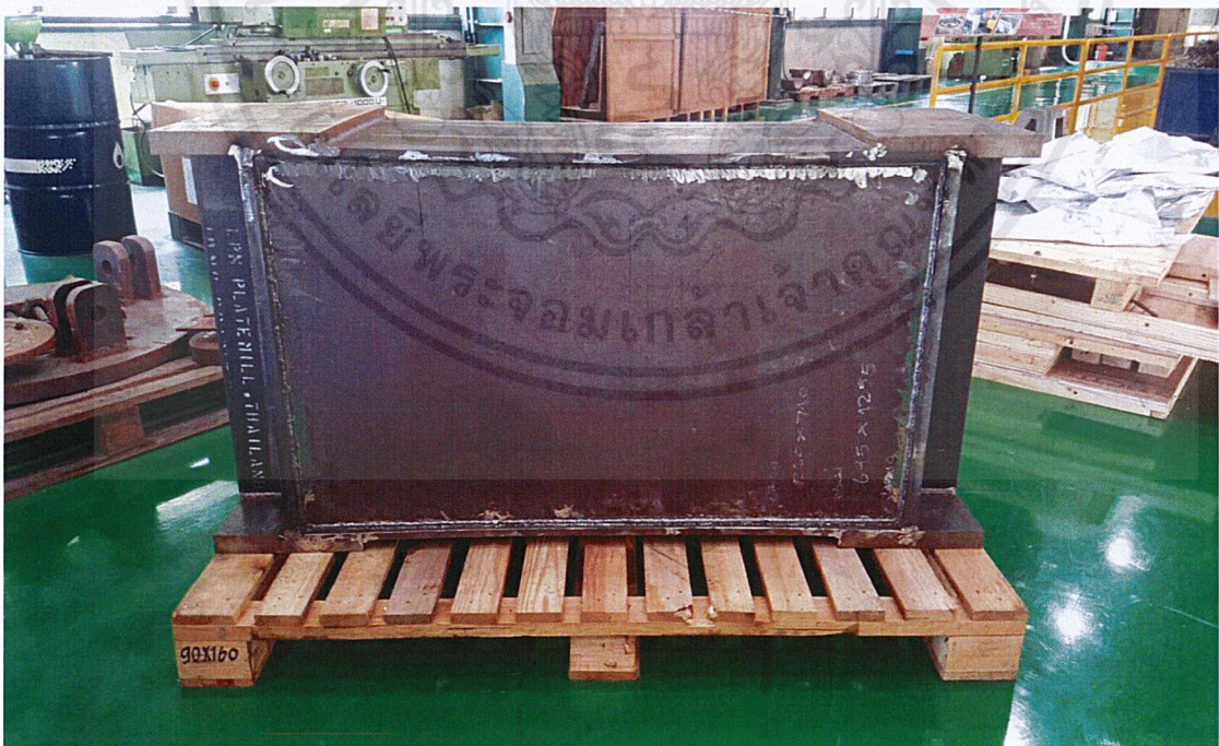
รูปที่ 3.51 ซัพพอร์ตเชื่อมประกอบแล้วเสร็จ
