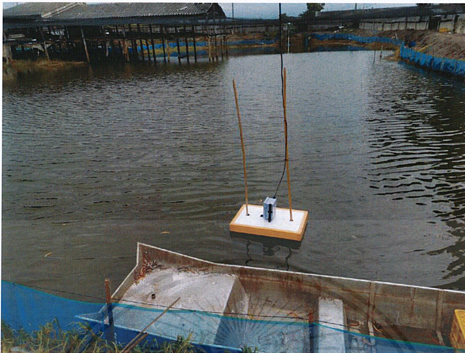
รูปที่ 3.22 จุดติดตั้งเครื่องตรวจวัดคุณภาพน้ำในบ่อเลี้ยงปลา
