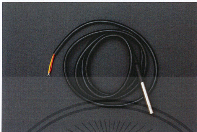
รูปที่ 3.4 Waterproof DS18B20 Digital Temperature sensor
