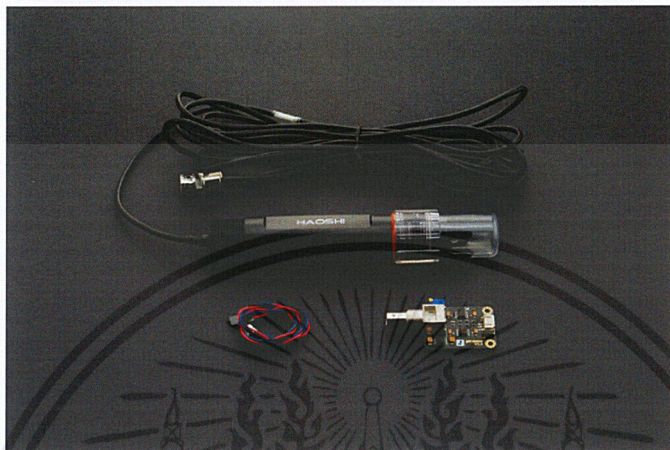
รูปที่ 3.2 Gravity : pH analog sensor
