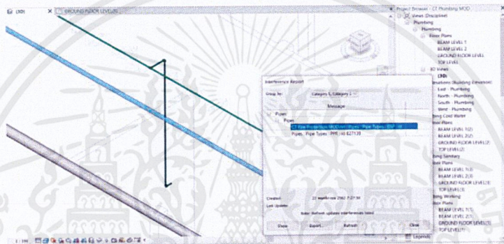
รูปที่ 5.8 แสดงผลทับซ้อนกันของระบบท่อ
