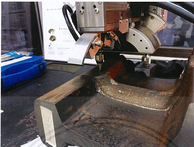
รูปที่ 3.12 แสดงการจัดชิ้นงานวัดความเค้นตกค้างตามแนวตัดขวาง
