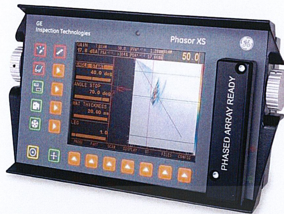
รูปที่ 3.4 แสดงเครื่องทดสอบด้วยคลื่นเสียง
