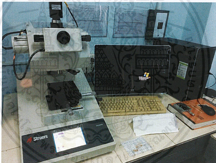
รูปที่ 3.16 แสดงเครื่องวัดความแข็งแบบไมโครวิกเกอร์
