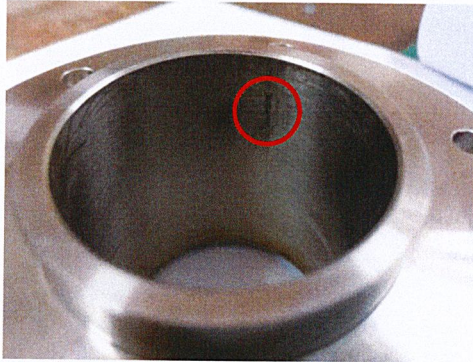
รูปที่ 5.7 ความเสียหายบริเวณภายในของฐานโคมรับความร้อน
