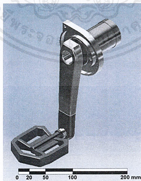
รูปที่ 3.10 ภาพแสดงส่วนประกอบของขางานพร้อมร่องนำการเคลื่อนที่ของขางาน
