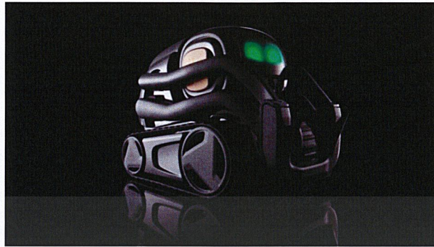
รูปที่ 2.3 หุ่นยนต์ที่ใช้สายพานในการเคลื่อนที่ (Anki Vector)
