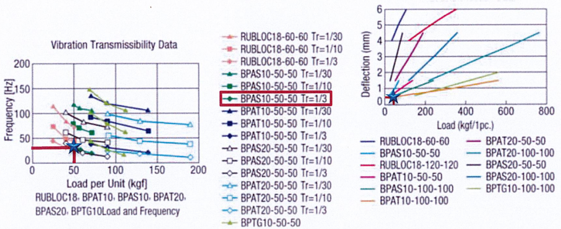
รูปที่ 3.8 การเลือกแผ่นกันสั่น
