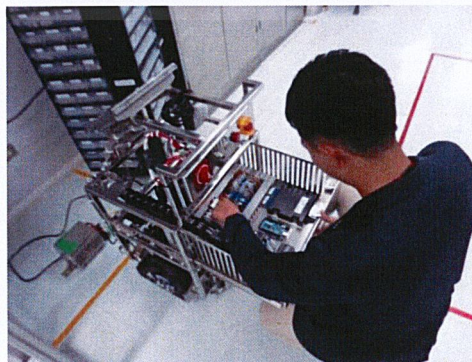
รูปที่4.15 กล่องระบบควบคุม
