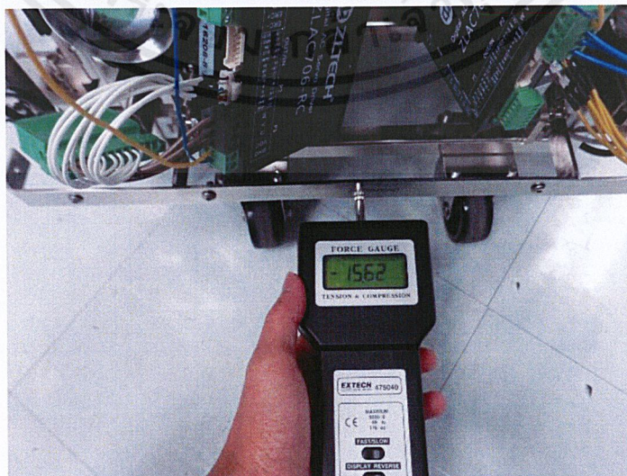
รูปที่4.17 การตรวจวัดแรงขณะเกิดการชน
