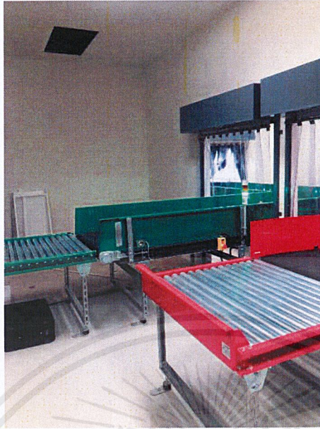
ภาพที่ 2.17 สายพานที่ใช้ในการส่งกระเป่ากลับเข้าไปสายพานหลัก
