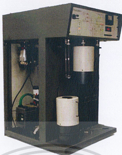
รูปที่ 2.11 เครื่องวัดพื้นที่ผิวและขนาดอนุภาครูพรุน (The Brunauer-Emmett-Teller, BET) (ศูนย์เทคโนโลยีโลหะและวัสดุแห่งชาติ, 2560)
