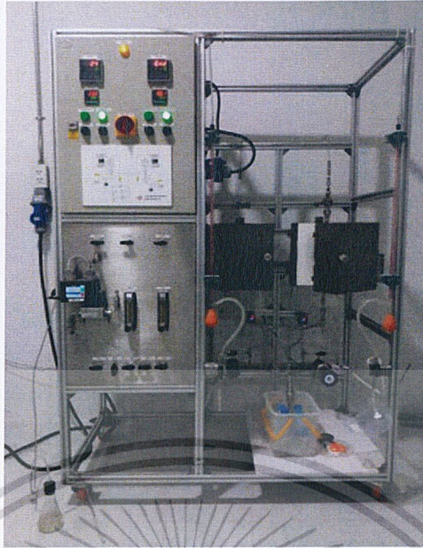
รูปที่ 3.2 ชุดเครื่องปฏิกรณ์แบบเบดนิ่ง (Fixed-bed reactor)
