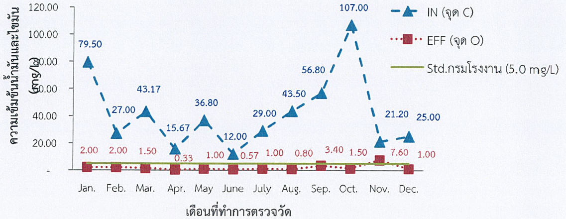
รูปที่ 4.2 ความเข้มข้นน้ำมันและไขมันในน้ำเสียจากจุด C และจุด O ปี 2561 (n=1)
