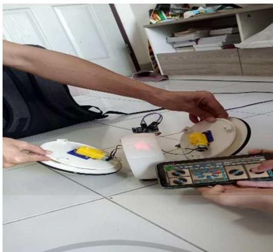
ภาพที่ 4.2 แสดงการทดลองการสั่งเลี้ยวไปทางขวา
