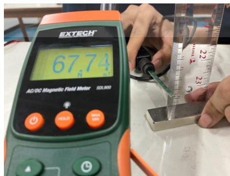
รูปที่ 3.4 การทดสอบวัดค่าสนามแม่เหล็ก ณ ระยะห่างใด ๆ เทียบกับผิวแม่เหล็ก
