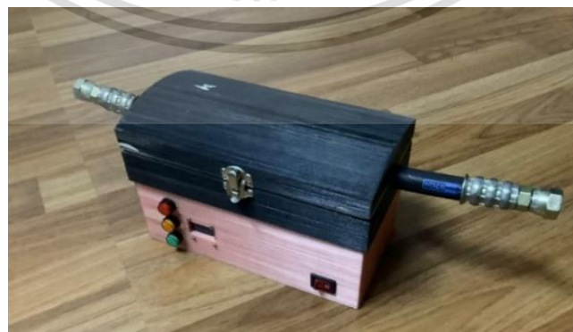
รูปที่ 3.13 อุปกรณ์จับยึดสายไฮดรอลิกรุ่นที่สองที่เสร็จสมบูรณ์
