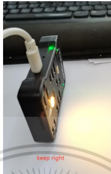
รูปที่ 3.18 วางบอร์ดไว้ทางด้านขวาแล้วกดปุ่ม ok เพื่อบันทึกการตั้งค่า ที่มา: http://pix.rctoosky.com/accelerometer-calibration.html
