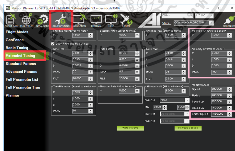
รูปที่ 2.18 โหมด Loiter รวมตัวควบคุมระดับความสูงจากโหมด Alt Hold
