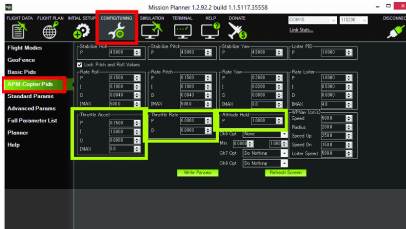
รูปที่ 2.13 การจูน Altitude Hold P
