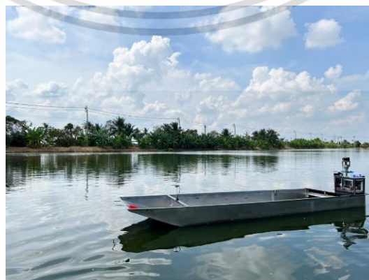
รูปที่ 3.12 เรืออัตโนมัติที่เสร็จสมบูรณ์
