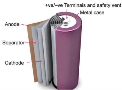
รูปที่ 2.23 ส่วนประกอบของแบตเตอรี่ลิเธียม
