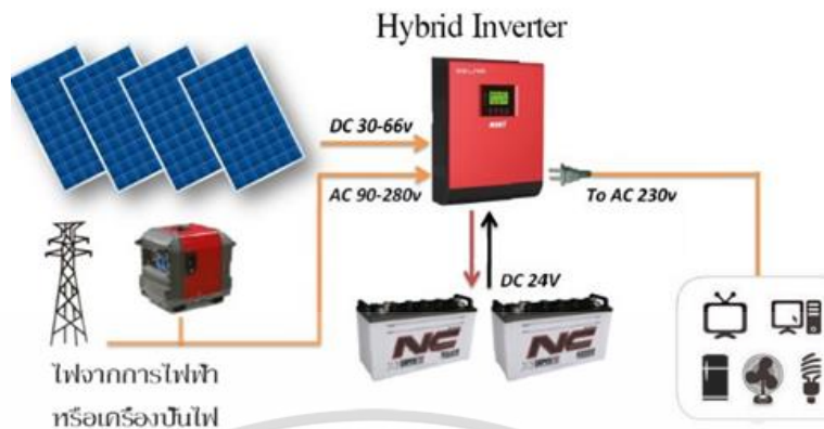
รูปที่ 2.16 แผงโซลาร์เซลล์ได้รับพลังงานแสงอาทิตย์แปลงเป็นพลังงานไฟฟ้ากระแสตรง (DC) ที่มา: https://www.gump.in.th/uploaded_files/img/solarcell/hybrid_system.jpg
