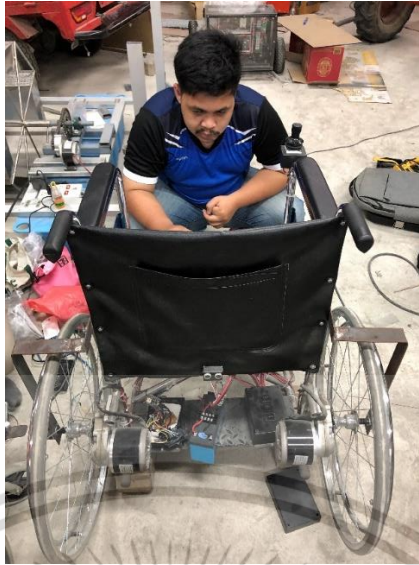
รูปที่ 3.12 ทดลองต่อสายจากตัวเอ็นเข้าไปยัง Arduino Mega 2560
