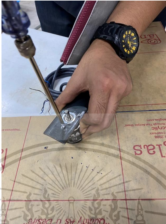
รูปที่ 3.10 เจาะรูตีปเกลียวที่ตัวเอ็นโค้ดเดอร์
