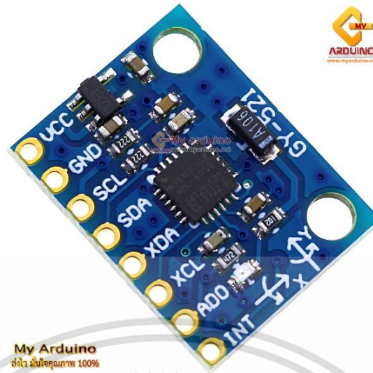
รูปที่ 3.8 จัดซื้อ GY-521 หรือ Gyro Module 6050
