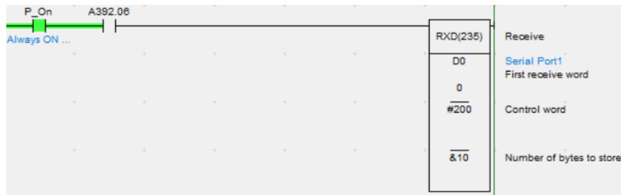
รูปที่ 3.12 แสดงการรับข้อมูลจาก RFID Reader ด้วยบล็อก RXD(235) เพื่อเปรียบเทียบกับฐานข้อมูลที่สร้างไว้
