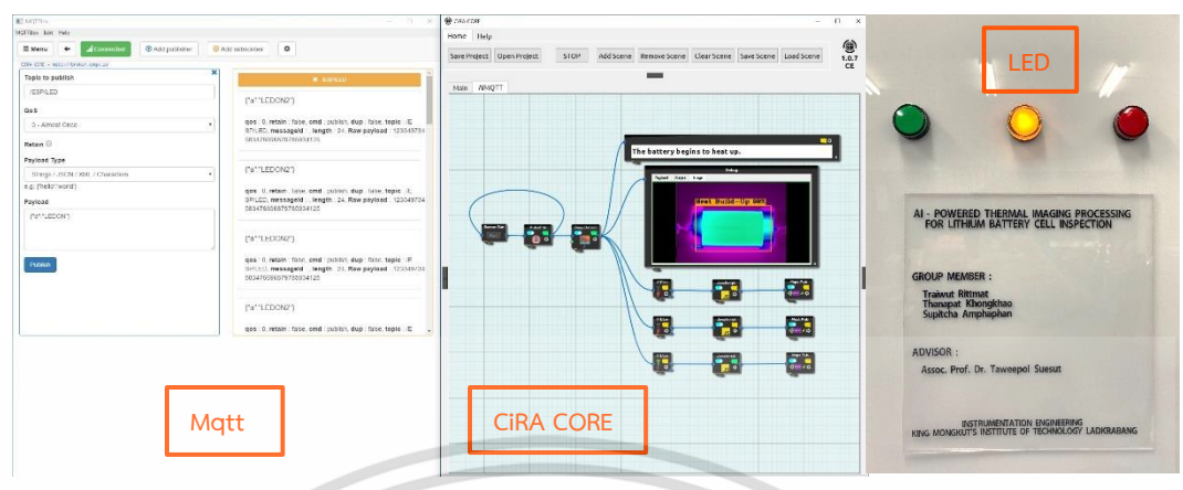
รูปที่ 3.28 ตัวอย่างการตรวจจบบatteryที่มีอุณหภูมิความร้อนสะสมพร้อม LED แสดงสถานะสีเหลือง
