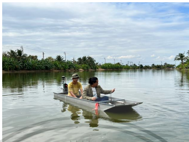
รูปที่ 4.3 ทดลองเรือในขณะที่มีโหลด 150 กิโลกรัม
