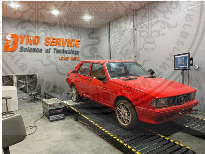
รูปที่ 4.1 การทดสอบรถยนต์ไฟฟ้าดัดแปลงขณะอยู่บนเครื่อง Dynamometer
