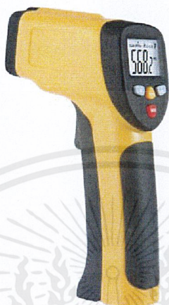
รูปที่ 3.9 เทอร์โมสแกนที่ใช้ในการวัดอุณหภูมิของขวดแก้ว
