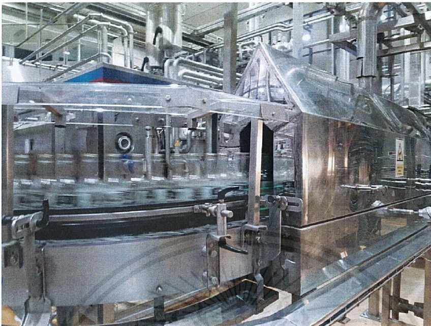
รูปที่ 3.4 อุโมงค์ไอน้ำสำหรับการเตรียมอุณหภูมิขวดก่อนเข้าการบรรจุ
