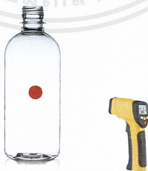
รูปที่ 3.12 ตำแหน่งในการวัดอุณหภูมิผิวขวดแก้ว
